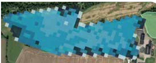
Bilde 5. Eksempel på fordelingskart for gjødselmengde som overføres til geospreder. De mørkeste feltene markerer 18,2 kg N/daa og de lyseste 7,8 kg N/daa.
