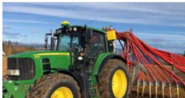
Bilde 3. HarvestLab 3000 NIRS-sensor påmontert slangespreder for måling av tørrstoff, total-nitrogen, ammonium, fosfor og kalium i husdyrgjødsl. Sensoren sitter inne i den gule boksen.
